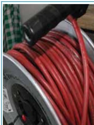
Oftmals ist die Stromversorgung unterbrochen. Sorgen Sie mit geeigneten Verlängerungskabel und Kabeltrommeln vor. Achten Sie auf Feuchtraumqualität.
